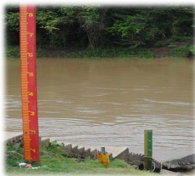
Muestra de las reglas limnimétricas que se colocan en los ríos, cuenca del Chucunaque, 2011
