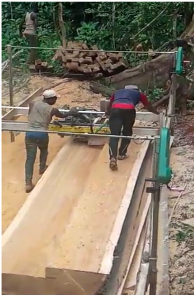
Photo 7: Des travailleurs en action dans une unité de transformation, appartenant à une opératrice, permettant de débiter le bois avec une Lucas Mill en forêt: Un travail épuisant et nécessitant une force physique importante et de l'endurance
