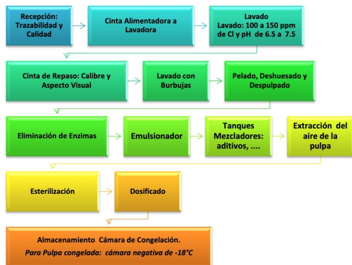
ILUSTRACIÓN 3-22 DIAGRAMA DE FLUJO DE UNA LÍNEA DE DESPULPADO DE MANGO 3000 KG/HORA. FUENTE: YANEZ (2015)
