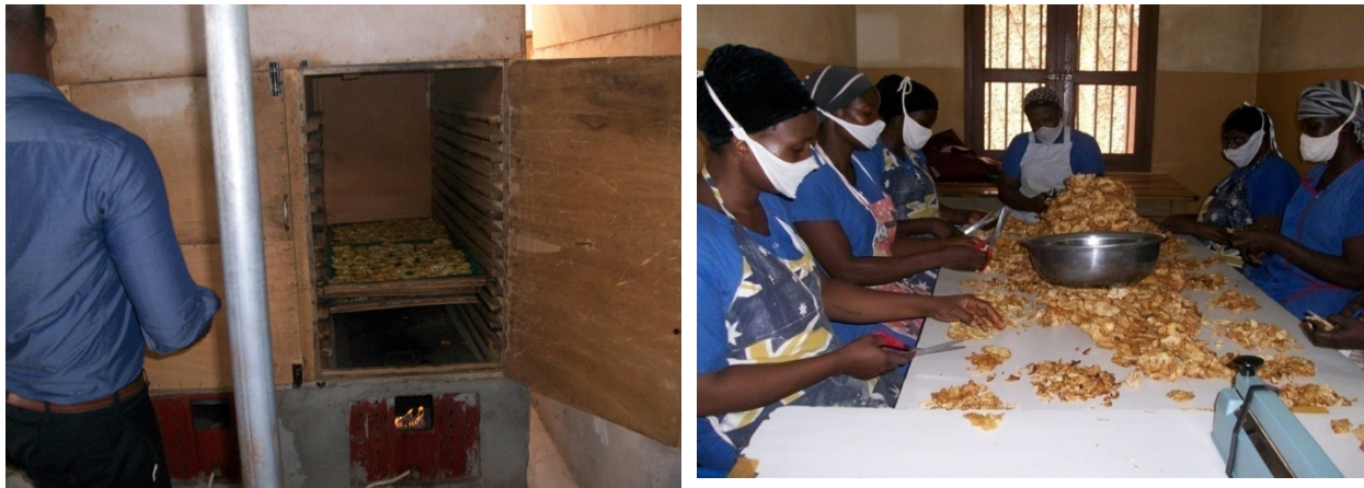
FIGURE 5 . FOURS DE SECHAGE D'ANANAS ET DECOUPAGE DES ANANAS SECHES APRES LEUR SORTIE DES FOURS
