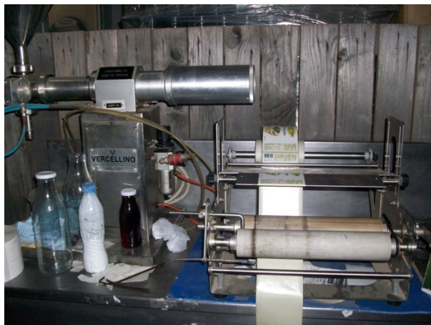
FIGURE 8 . MACHINE PERMETTANT DE COLLER LES ETIQUETTES SUR LES BOUTEILLES (ENTREPRISE EDM-DISTRIBUTION)
