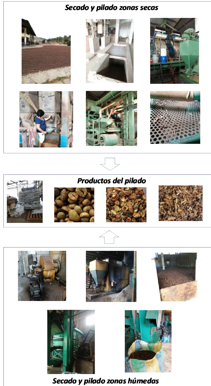
FIGURA 2-18 PREPARACIÓN DEL CAFÉ NATURAL PARA LA INDUSTRIA : SECADO Y PILADO Fuente: elaboración propia
