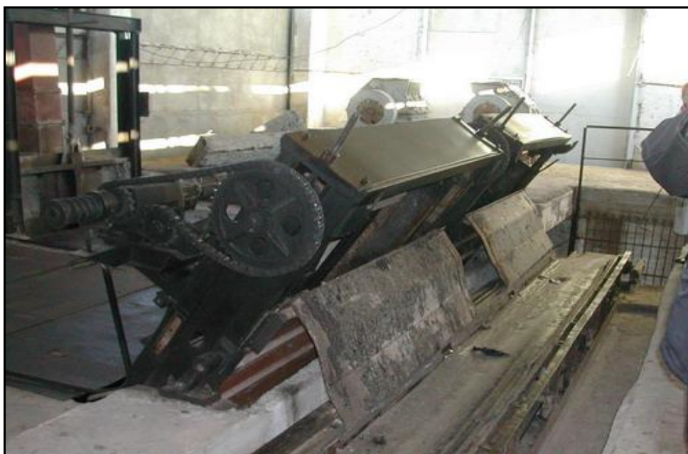
Рисунок 0-2 Восстановленные и отремонтированные решетки
