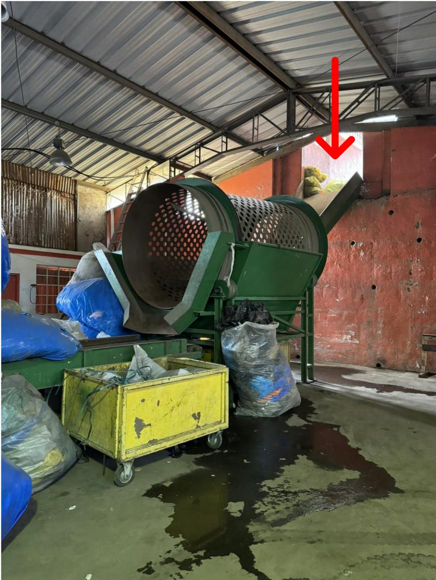
El material que llega a la planta sin seleccionar ingresa por la rampa y es seleccionado en la máquina que se muestra en la foto de la derecha.
