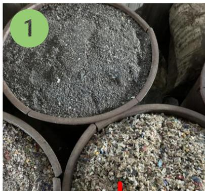
**1-2** Una vez se tritura el material se preparan sacos con las proporciones de material necesario para formar el producto. Este material se introduce en una máquina que lo mezcla con el colorante.
