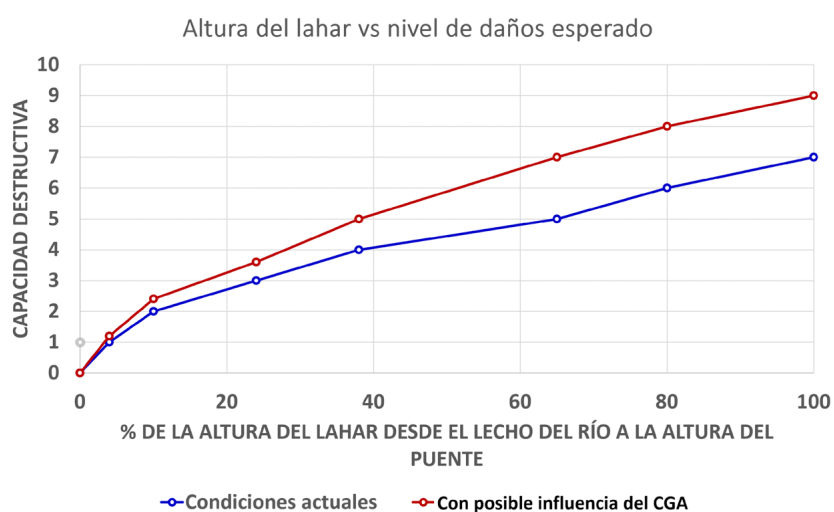
Figura 32. Gráfico de correlación entre el tamaño del lahar, según su tirante en el sitio del puente, expresado en % de la altura del lahar desde el lecho del río a la altura del puente vs. el daño que se generaría en el puente. La curva roja simula el incremento supuesto de la capacidad destructiva de los lahares en caso de que el CGA incremente la intensidad, duración, frecuencia y volumen de las precipitaciones pluviales en alrededor de 5%. Nótese que LAHARZ no puede realizar directamente este tipo de modelos.
