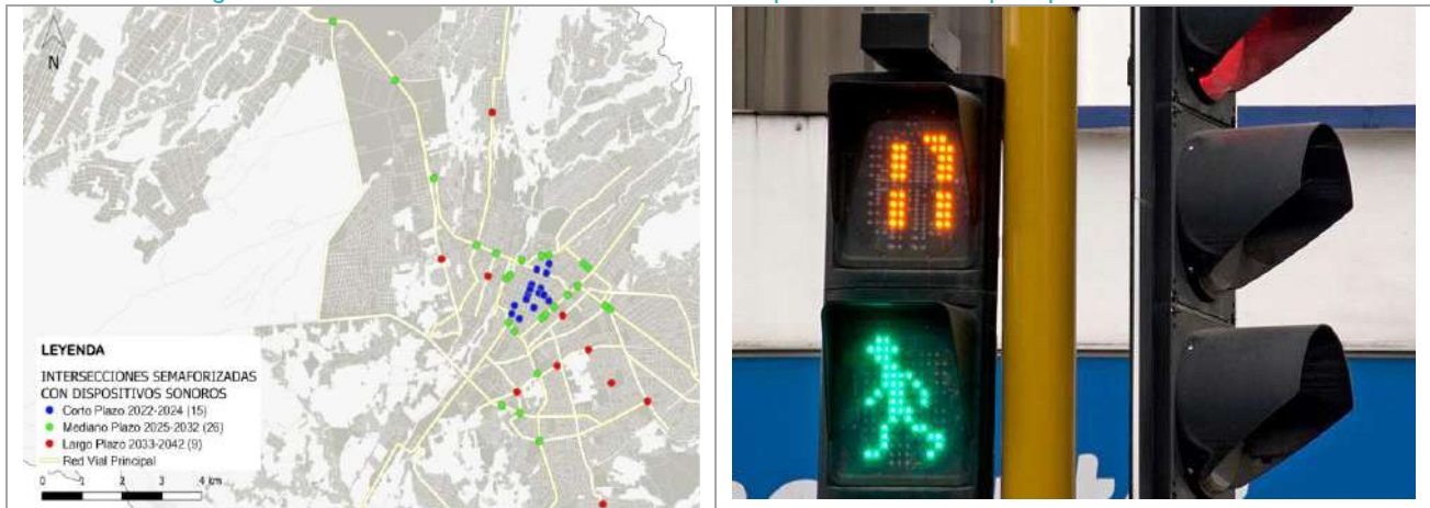
Figura 112. Intersecciones semaforizadas con dispositivos sonoros para personas invidentes
