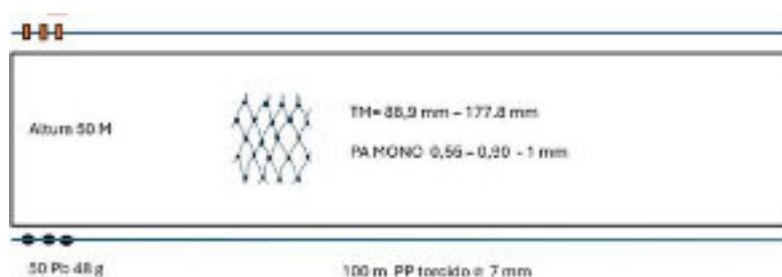
Esquema general de una red de enmalle para pesca por agallamiento
