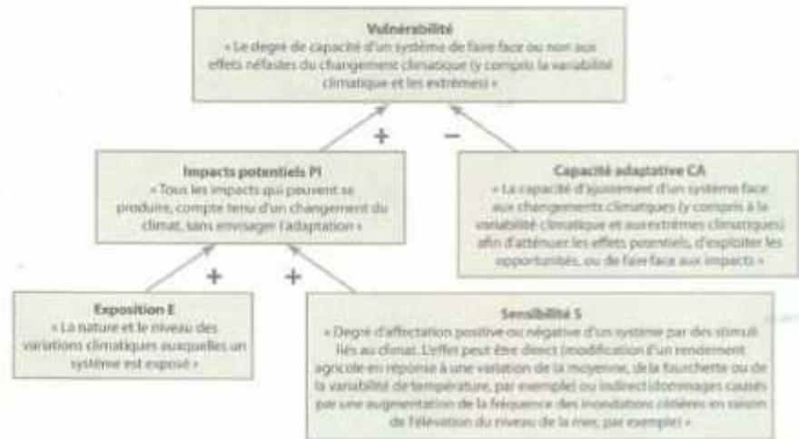
La figure ci-dessus montre les composantes de la vulnérabilité selon GIEC. Les signes sous flèches signifient qu'une forte exposition, une forte sensibilité et une faible capacité adaptative induisent une forte vulnérabilité.
