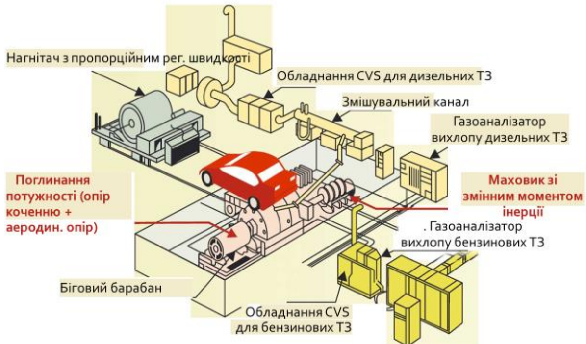
Рисунок 4.11. Спрощений приклад лабораторного випробувального стенду для вимірювання паливної економічності та рівня викидів транспортного засобу
