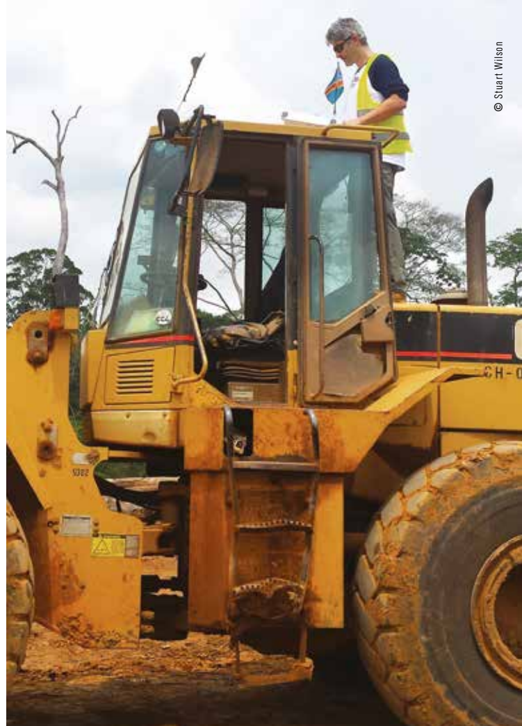
Photo 13 Installation du boîtier GPS sur un engin forestier
