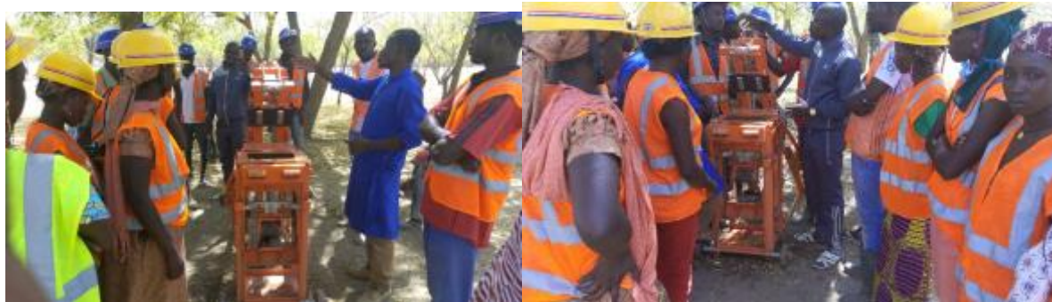
Formation pratique des jeunes en techniques de fabrication et de production des briquettes en terre stabilisées (BTS) par la valorisation de l'argile à Mora
