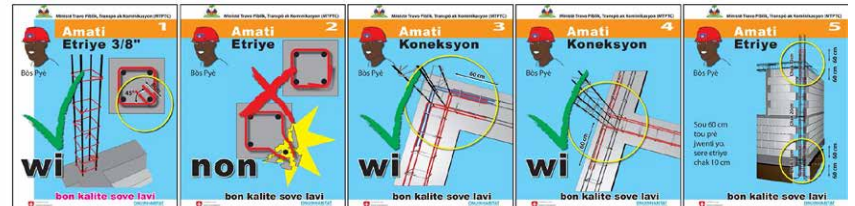
Construction sûre Les affiches du MTPTC pour le ferrailage
