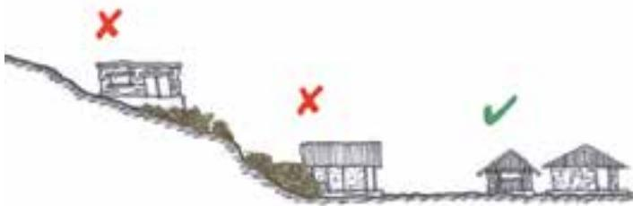
O local deve ser colocado em terreno estável; evitar a construção em aterros.
