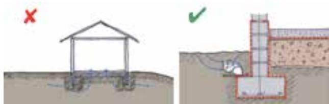
Construir fundações suficientemente profundas para evitar a sua erosão devido ao movimento da água.
