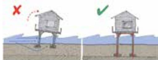
Construir o abrigo em sapatas contínuas ou estacas onde for adequado.
