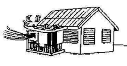
A pressão do vento pode levantar a varanda e destruí-la
